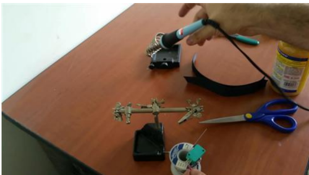
Soldando el pulsador (switch) al cable con el jack.
