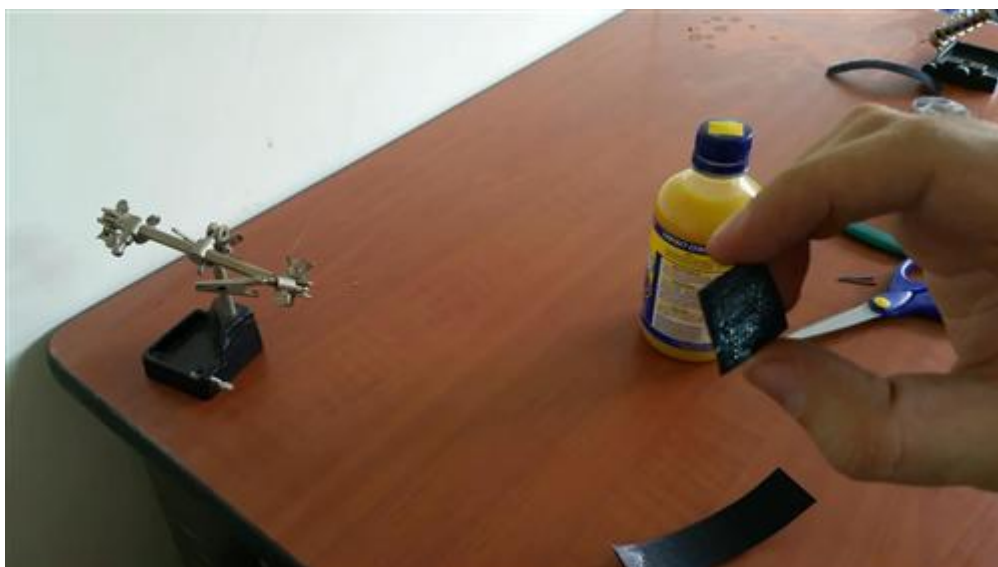
Creando la correa con velcro para ajustar el pulsador al dedo.
